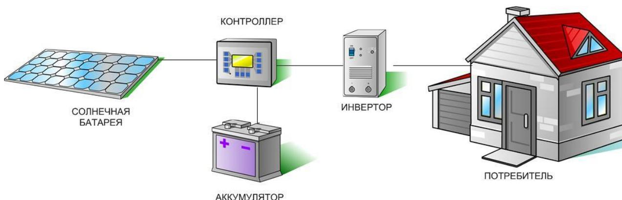
Солнечная энергетическая установка преобразует энергию солнечного света в электрическую энергию. Принцип работы солнечных панелей основан на фотоэлектрическом эффекте, который возникает в неоднородных полупроводниковых структурах при воздействии на них солнечного излучения. В условиях Казахстана - это щедрые 1400 Вт на м<sup>2</sup> поверхности в среднем.
